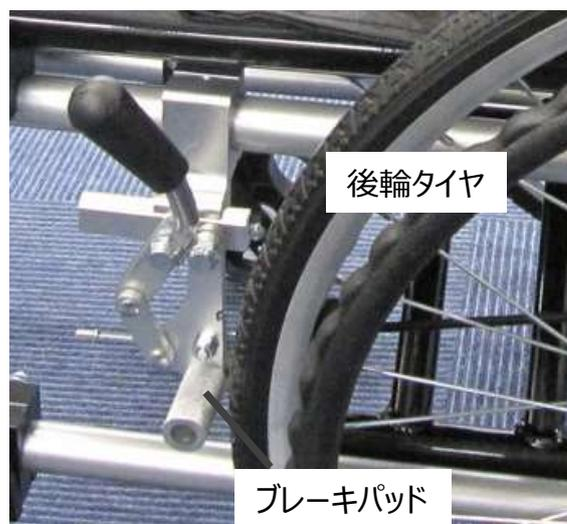
ブレーキ調整は後輪付近にある○印部分のブレーキ調整ナットで行います。
