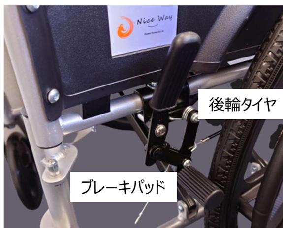
ブレーキ調整は後輪付近にある□印部分の3つのナットでブレーキ調整を行います。
