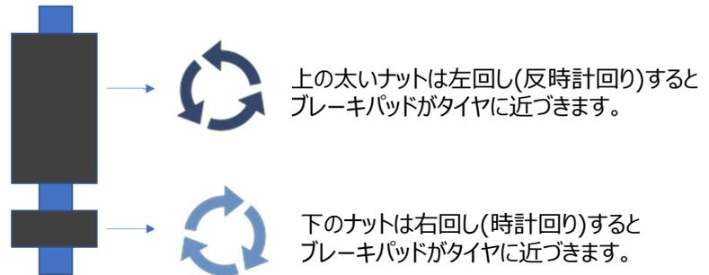
ブレーキパッドをタイヤに近づけ過ぎるとブレーキパッドがタイヤに接触し、走行できなくなるのでご注意ください。
