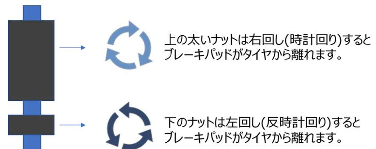
ブレーキパッドがタイヤから離れ過ぎるとブレーキレバーを引いてもブレーキパッドがタイヤに接触しなくなりブレーキが効かなくなりますのでご注意ください。
