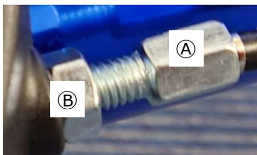
Ⓐのナットを固定しながらⒷのナットを回してブレーキ調整を行います。
